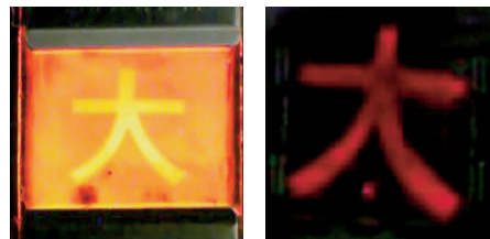
各種素材に発光材料を印刷し、発光させた様子 [左] ガラス板に印刷、[右] 布に印刷
