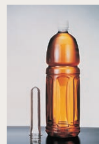
左：成型前のプリフォーム 右：成型されたPETボトル
