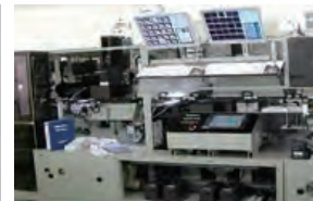
印刷物の絵柄検査装置
