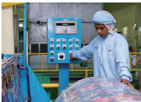
印刷されたフィルムの巻取りを行う様子
